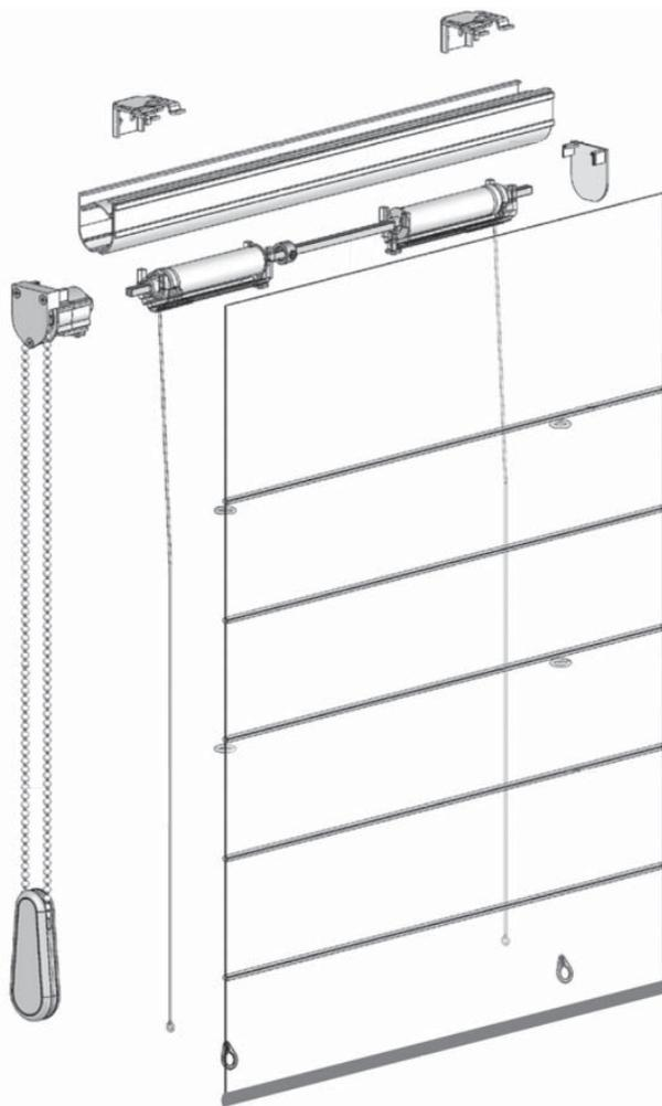
При заказе карниза необходимы такие данные: 1) габариты карниза, 2) Блок механизма 1:1 или 1:4, 3) количество суппортов (шнуров), 4) высота цепочки, 5) сторона управления, 6) количество прутков, 7) наличие утяжелителя для цепочки
